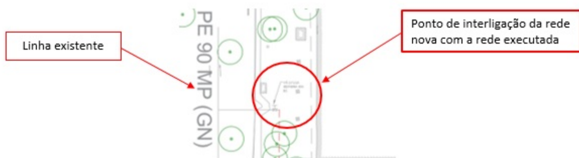
figura 3 – ponto de interligação da rede existente (rede interna de Gás Natural)
